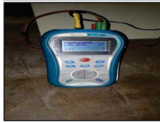
ขณะทำการวัดค่าความต้านทานดิน
