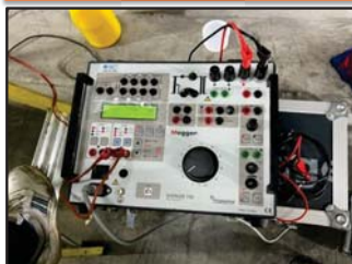
ขณะทำการทดสอบ Protection Relay
