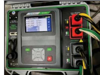
ขณะทำการทดสอบ Windin & Turn Ratio
