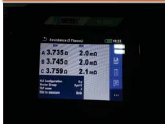
ขณะทำการทดสอบ Winding & Turn Ratio
