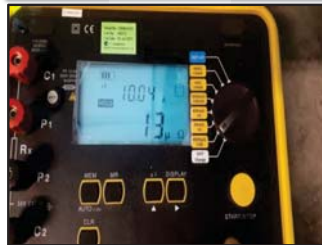
ขณะทำการทดสอบ Contact Resistance
