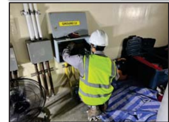
ขณะทำการวัดค่าความต้านทานดิน
